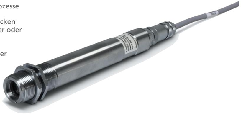
Das IMPAC ISR 320 ist ein stationäres, digitales, kompaktes und schnelles Quotientenpyrometer für die berührungslose Temperaturmessung. Das Pyrometer misst nach dem 2-Farben-Prinzip (Verhältnis-Prinzip), bei dem die Temperatur aus dem Verhältnis der Intensitäten zweier benachbarter Wellenlängen bestimmt wird.
